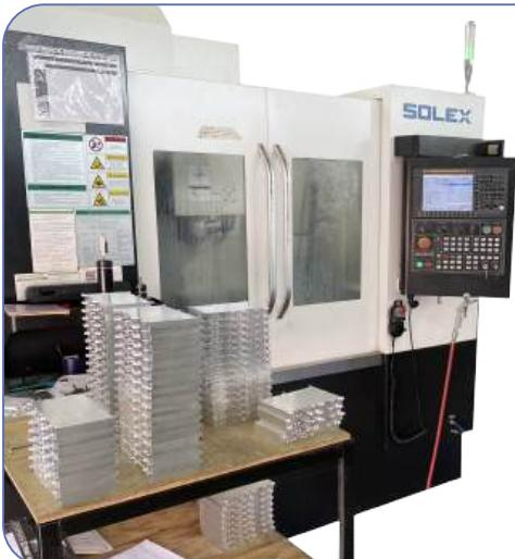
При подключении 4 оси получаем высокоточные и качественные детали с определенной степенью шероховатости поверхности (до Ra 08 ), точностью до 0,01 мм.
